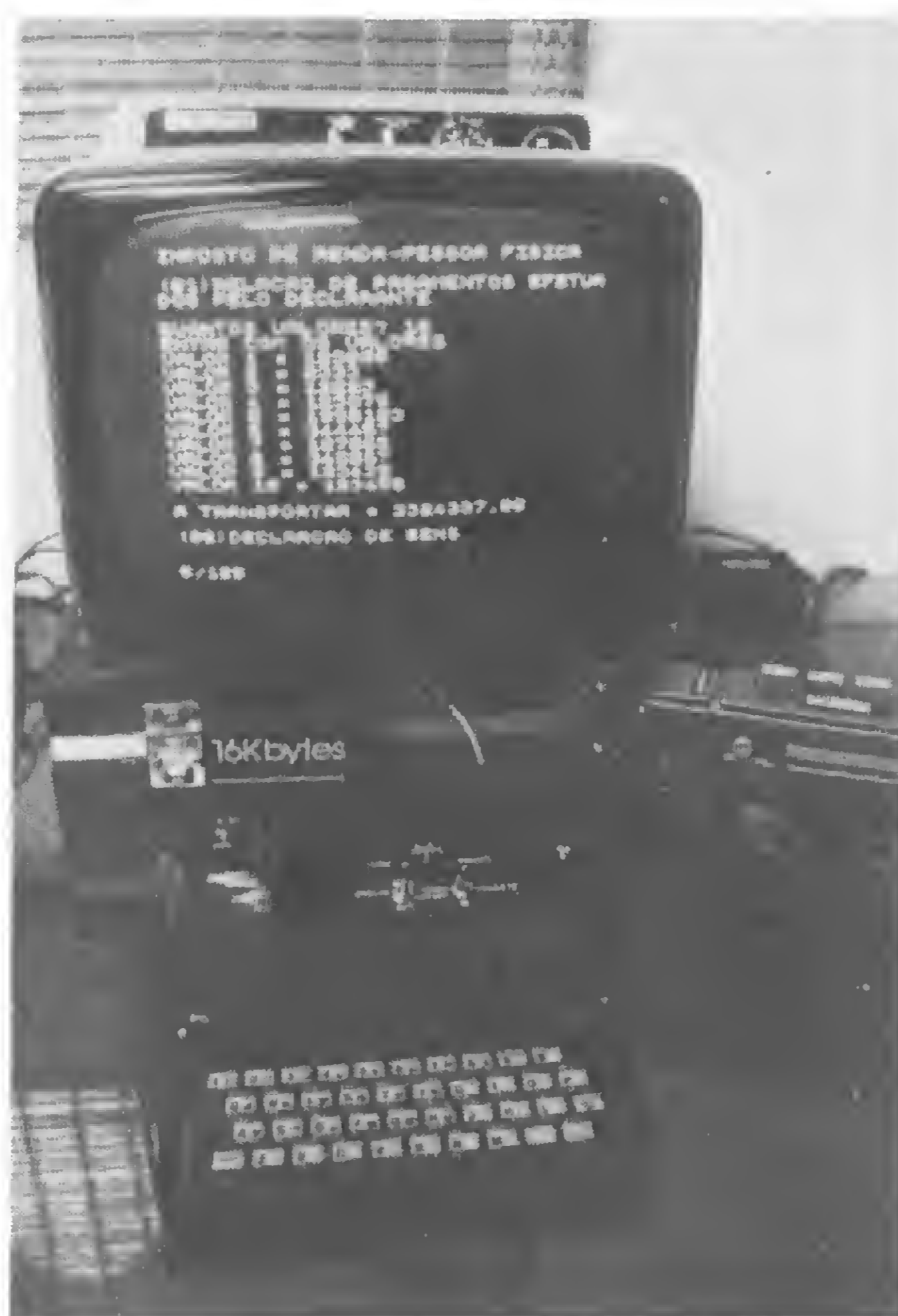
Com o inversor de vídeo adaptado por Sérgio, o TK pode fornecer imagens em fundo preto ou branco, conforme desejar o usuário. Note-se as chaves adaptadas na parte externa do aparelho
